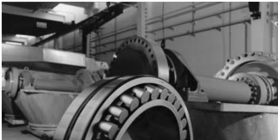
Rodamientos oscilantes de rodillos para apoyo del rotor.
